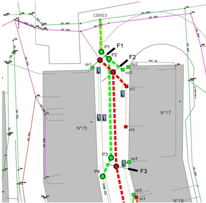
Esta conducción tiene por objeto conseguir cota para conducir las aguas de lluvia, que actualmente vierten a la red unitaria, a la línea pluvial que baja paralela a las escaleras (pozo 126923).
