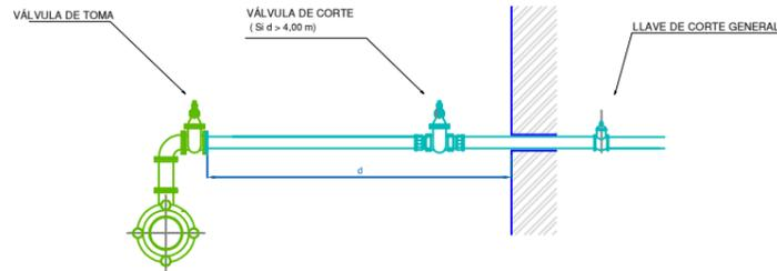
DERIVACION MEDIANTE TE CON SALIDA Ø\*, CARRETE BB Ø\* y CODO 90º BB Ø\*
