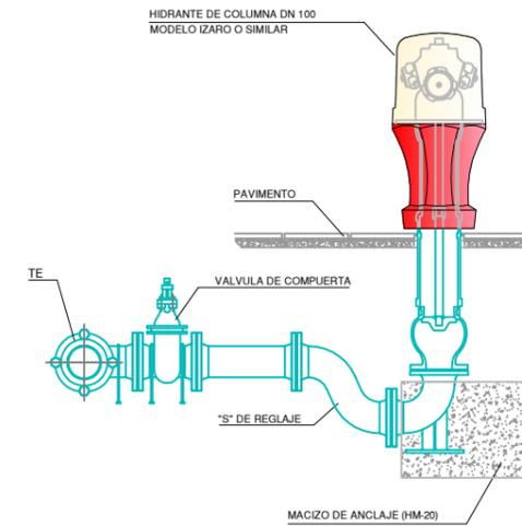
DERIVACION MEDIANTE TE EEB CON SALIDA A DN 100
