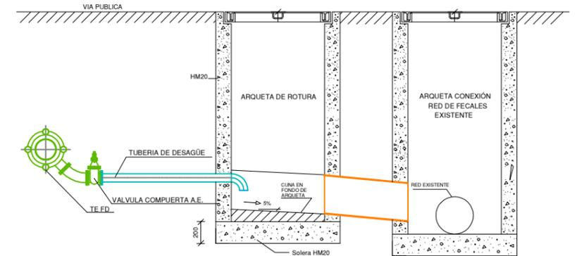
DERIVACION MEDIANTE TE EEB CON SALIDA Ø EN FUNCIÓN DEL CAUDAL A DESAGUAR
