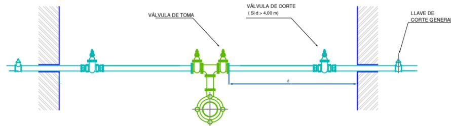
DERIVACION MEDIANTE TE EEB CON SALIDA A Ø\*, CARRETE BB Ø y TE\*\* FD BB Ø
