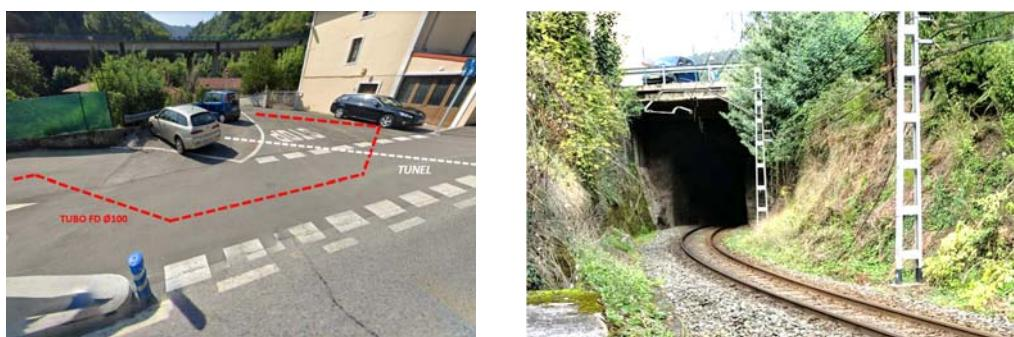
Se instalará un ramal adicional de Ø 63mm para abastecer los números 6 y 8 de Azitain bide. Se renovarán todas las acometidas afectadas hasta el límite de propiedad particular.
