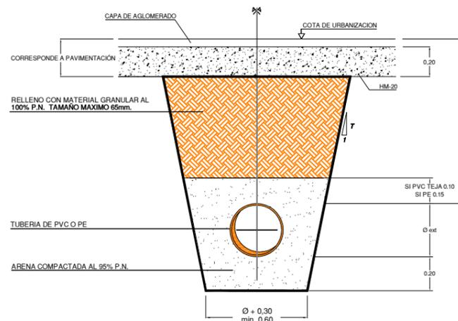
SECCION ZANJA TIPO III
