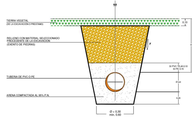
SECCION ZANJA TIPO IV
