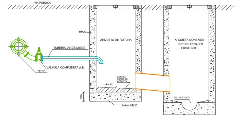
DERIVACION MEDIANTE TE EEB CON SALIDA Ø EN FUNCIÓN DEL CAUDAL A DESAGUAR
