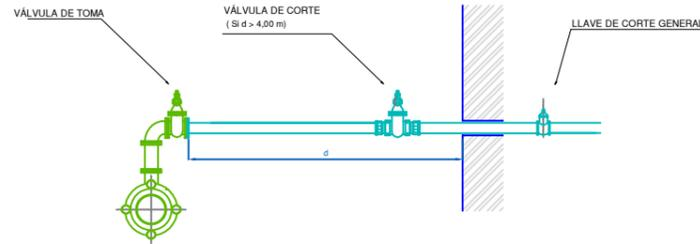
DERIVACION MEDIANTE TE CON SALIDA Ø\*, CARRETE BB Ø\* y CODO 90° BB Ø\*
