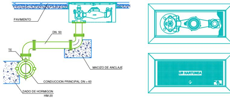
DERIVACION MEDIANTE TE EEB CON SALIDA Ø 50, CARRETES BB Ø50 y CODOS 90° BB Ø50
