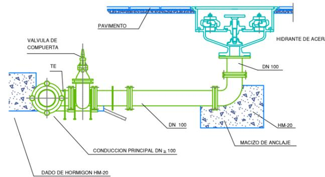
DERIVACION MEDIANTE TE EEB CON SALIDA Ø 100, CARRETE BB Ø100 y CODO 90° BB Ø60
