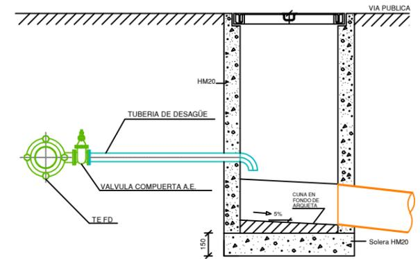
DERIVACION MEDIANTE TE EEB CON SALIDA Ø EN FUNCIÓN DEL CAUDAL A DESAGUAR
