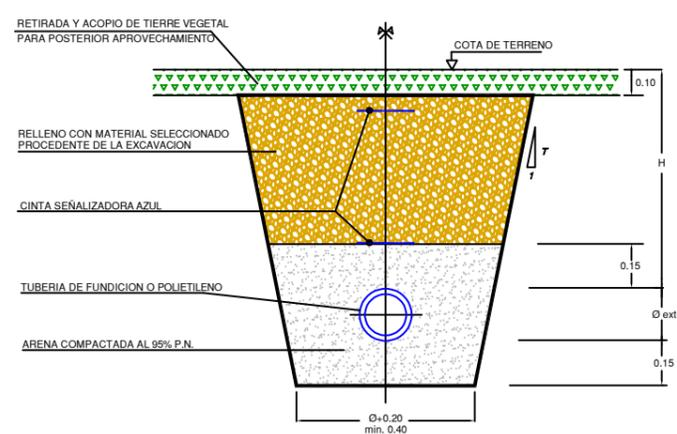
NOTA:  $H \geq 0.85m$ . PARA TUBERIAS  $\varnothing > 100mm$ .
