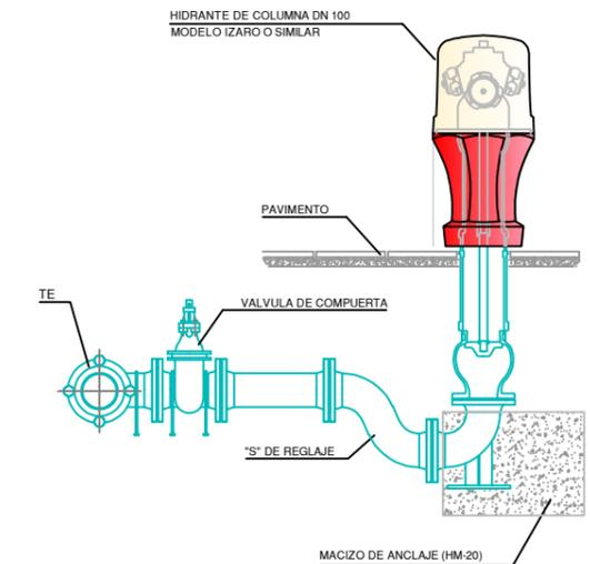
DERIVACION MEDIANTE TE EEB CON SALIDA A DN 100
