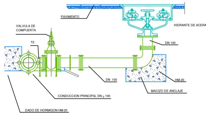
DERIVACION MEDIANTE TE EEB CON SALIDA Ø 100, CARRETE BB Ø100 y CODO 90º BB Ø60
