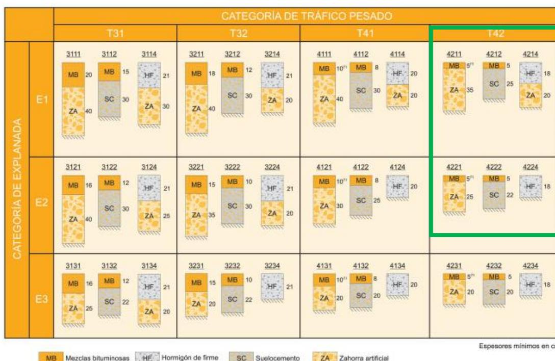
(1) Estas capas bituminosas podrán ser proyectadas con mezclas bituminosas en caliente muy flexibles, gravaemulsión sellada con un tratamiento superficial o mezcla bituminosa abierta en frío sellada con un tratamiento superficial.
