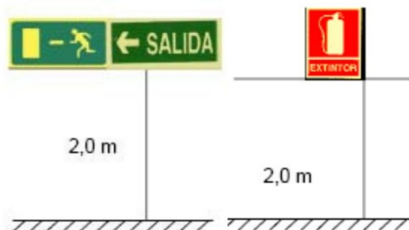
Los medios de protección contra incendios de utilización manual (extintores y pulsadores manuales de alarma) se deben señalar mediante señales definidas en la norma UNE 23033-1 cuyo tamaño sea el descrito anteriormente.
