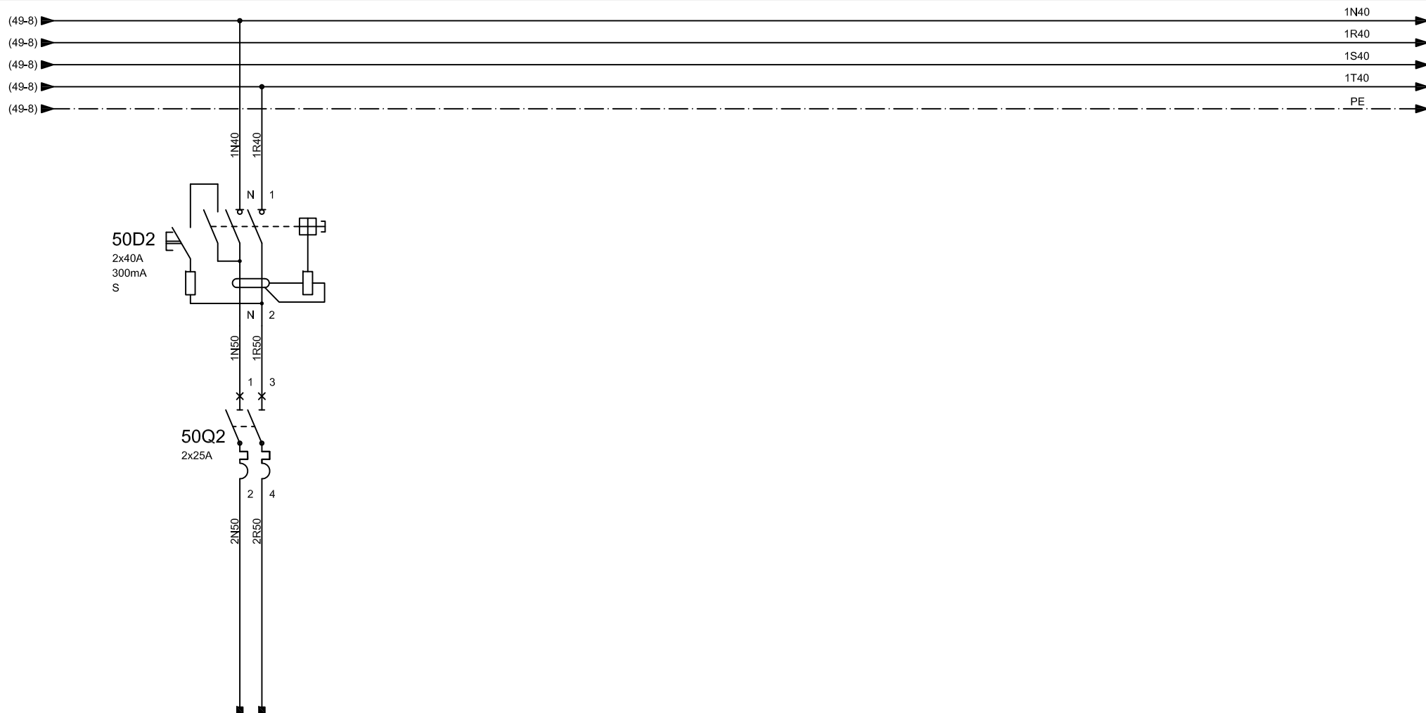
ALUMBRADO GALERÍAS PERIMETRALES CIRCUITO "A"
