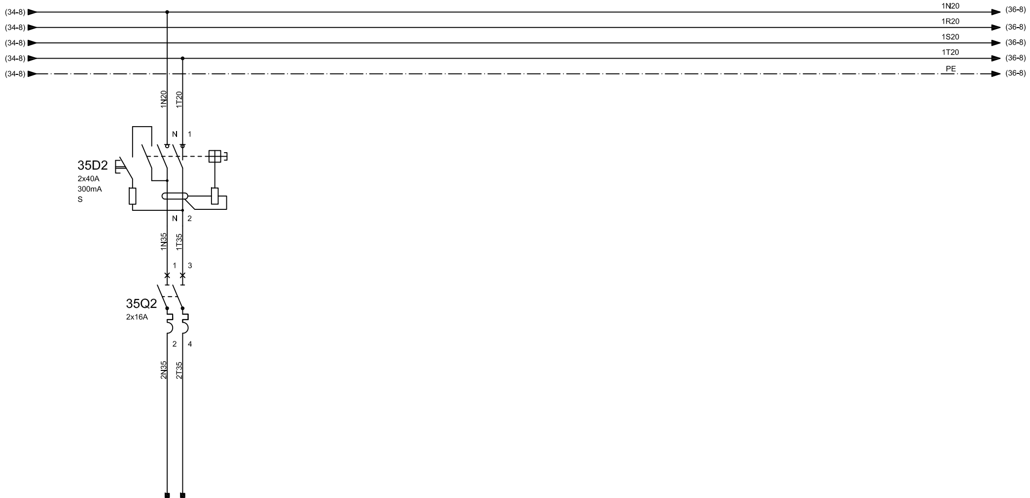
ALUMBRADO CÁMARA LLAVES CIRCUITO "B"
