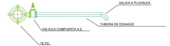
DERIVACION MEDIANTE TE EEB CON SALIDA Ø EN FUNCIÓN DEL CAUDAL A DESAGUAR
