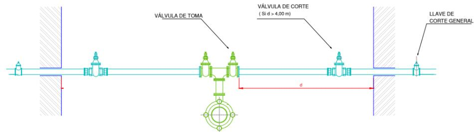
DERIVACION MEDIANTE TE EEB CON SALIDA A Ø\*, CARRETE BB Ø y TE\*\* FD BB Ø
