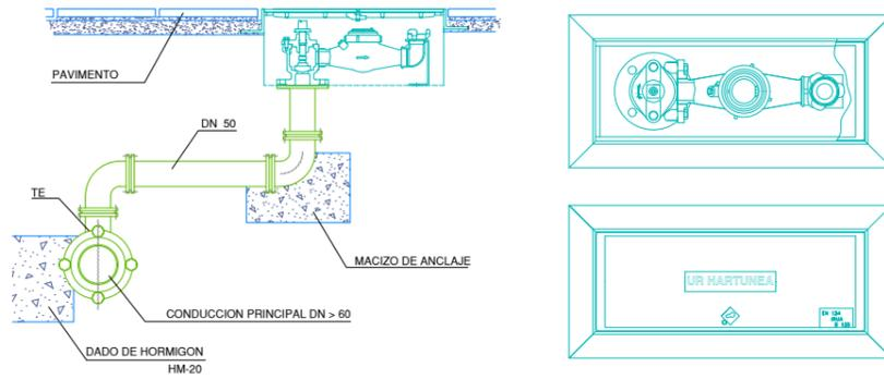
DERIVACION MEDIANTE TE EEB CON SALIDA Ø 50, CARRETES BB Ø50 y CODOS 90º BB Ø50
